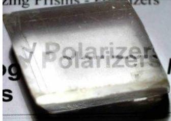
Ci-contre : double réfraction dans un cristal de calcite ; la double réfraction fait apparaître deux images du mot « Polarizers » à travers le cristal.
