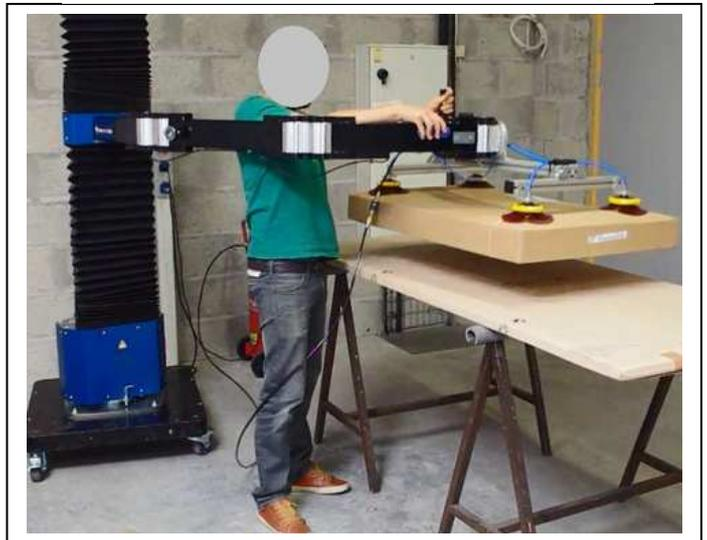
Pour notre étude nous supposons la pièce **1** fixe en hauteur et les deux bras **2** et **3** pouvant tourner respectivement autour des axes  $A \vec{z}_1$  et  $B \vec{z}_1$ . Nous sommes donc dans le cas d'un problème plan : le plan horizontal  $(A \vec{x}_1 \vec{y}_1)$ .
