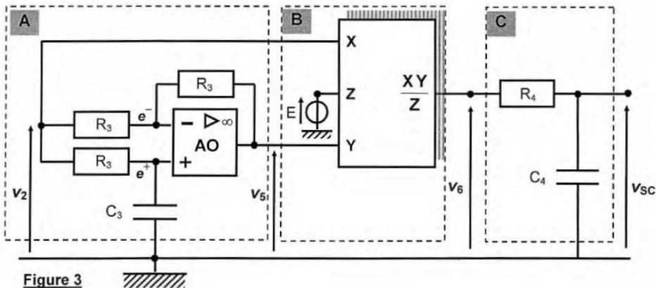
Le bloc B est un multiplieur réalisant la fonction  $v_6 = \frac{XY}{Z}$ .
