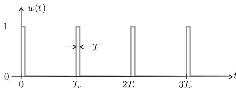
FIGURE 1 – Signal d'échantillonnage.
