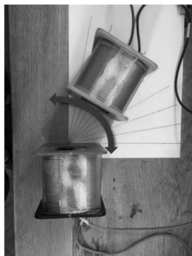
FIGURE 11 – Évolution du rendement en fonction de l'angle entre les bobines.
