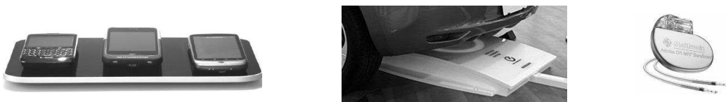
FIGURE 1 – Quelques applications de la transmission d'énergie sans fil, de gauche à droite : recharge de téléphone portable, recharge sans fil d'une voiture Nissan Leaf ® , pacemaker.
