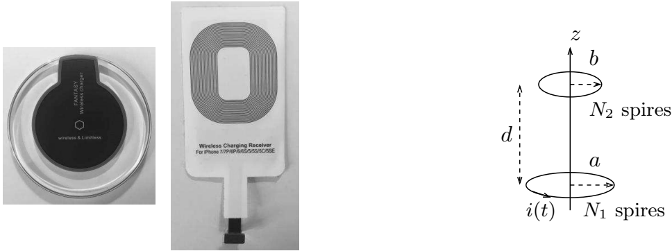
FIGURE 6 – À gauche : système de transmission classique (émetteur et récepteur) utilisé dans les chargeurs sans fil actuels. À droite : schéma et notations utilisées.
