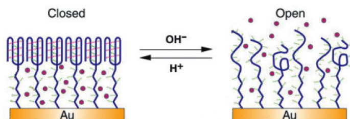
Fig. 49 : Ouverture et fermeture du nano-réservoir par variation du pH.
