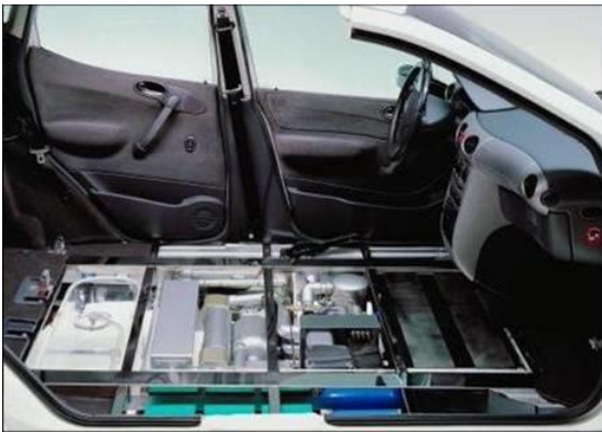
Plancher d'une voiture fonctionnant avec une pile à hydrogène
