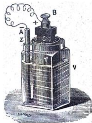
FIG. 153. — Pile Leclanché. — V, vase de verre renfermant une solution saturée de sel ammoniac; Z, cylindre de zinc amalgamé; T, vase poreux renfermant du bioxyde de manganèse ( MnO_2 ); C, charbon de corne.
