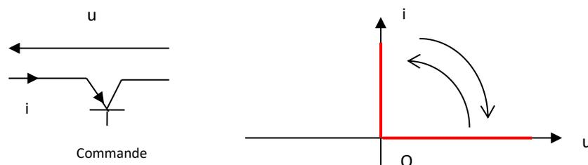
Les deux derniers types d'interrupteurs sont commandés par un circuit électronique extérieur associé à une horloge de fréquence donnée qui organise périodiquement leur ouverture et leur fermeture.
