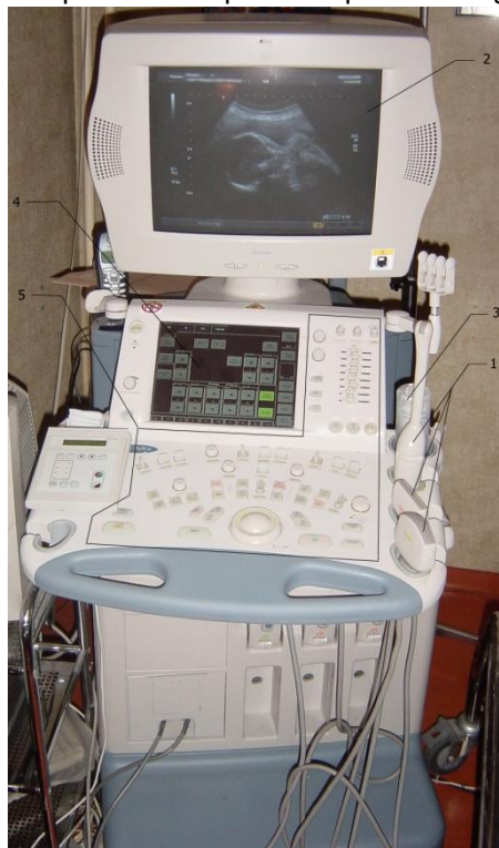
Légende : 1. Sondes 2. Ecran 3. Flacon de gel 4. et 5. Consoles de commande et d'acquisition
