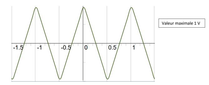
Sortie du passe bas pour f = 0,1f<sub>0</sub>: le signal est pratiquement inchangé
