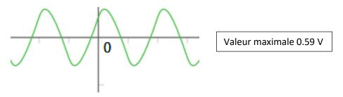
Sortie du passe-bas pour f = f<sub>0</sub> le signal est atténué et déformé
