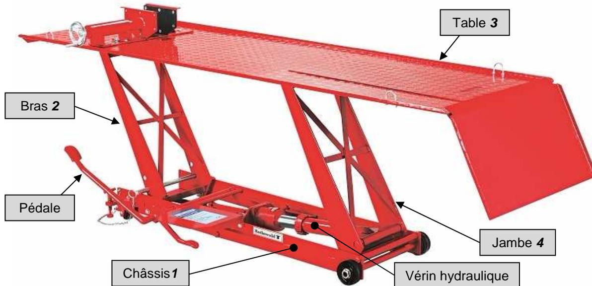
Une pédale manœuvrée par le pied permet d'alimenter un vérin hydraulique qui pousse la jambe 4. La table 3, sur laquelle est posée la charge  $Ch$ , est alors mise en mouvement. Une purge manuelle donne la possibilité de faire redescendre la table grâce à son propre poids.
