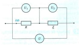
Déterminer le facteur de puissance du dipôle en fonction des indications des voltmètres et en déduire la puissance active reçue par le dipôle. On utilisera une méthode algébrique et une méthode géométrique.
